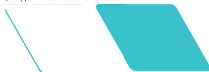
Figur 1 LIQOSEAL® med ett vidhäftande vitt skumlager och ett blått förseglande lager - schematisk ritning
