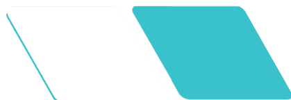
Figur 1 LIQOSEAL® med et klæbende, hvidt skumlag og et blått forseglingslag – schematisk tegning
