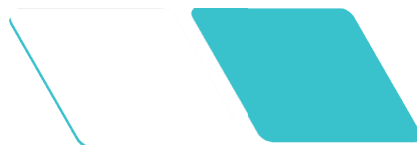
Figur 1 LIQOSEAL® med et klebende, hvitt skumlag og blått forseglingslag - skematisk tegning
